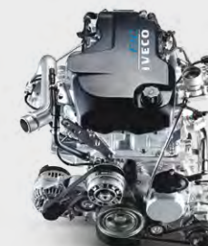
3,0-Liter-CNG-Motor F1C Leistung 136 PS und 350 Nm Drehmoment
